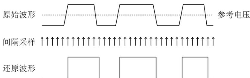
根据硬件设计上的差异，逻辑分析仪大致可分为独立式（或称单机型）或需结合电脑使用的虚拟式。金思特推出的逻辑分析仪产品均属于虚拟式逻辑分析仪。设备硬件根据设定的条件采集被测信号，然后将采样数据上传到电脑端的软件 KingstVIS。KingstVIS 软件将采集到的原始数据还原为数字波形显示到电脑屏幕上，并可以根据所支持的标准协议对数据进行解码，以及其它一些分析及测量功能。
