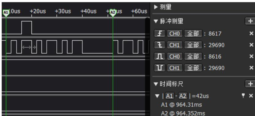
A1、A2 分别显示时间标尺 A1 和 A2 所在位置的时刻值；|A1-A2|显示的是两标尺间的时间差；上升沿显示鼠标所在通道的 A1 和 A2 之间的上升沿个数。
