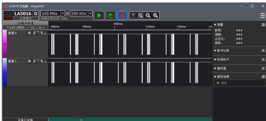
由图可见，当前的时间轴比例太大，导致有效信号波形被压缩在很小的一段内，根本看不清楚。此时，可以将鼠标移动到有效波形的的位置处，然后点击鼠标左键，即可放大波形。局部放大后的效果如下图。
