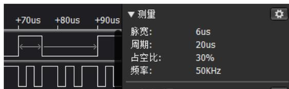
如上图，鼠标放在最上面通道的一个正脉冲位置上，这个脉冲和相邻的下一个负脉冲位置上就会出现箭头指示，右侧测量窗口内就会显示当前这个正脉冲的宽度为 6us，整个周期为 20us，此一周期内的占空比为 30%，此一周期对应的频率为 50kHz。
