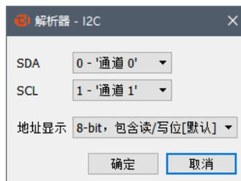
在弹出的对话框中，设置 SDA 为通道 0，SCL 为通道 1，点击“确定”，会自动在通道 0 和通道 1 上显示协议解析器中对应通道的名字，然后软件便会按照标准的 I2C 协议对通道 0 和 1 进行解析，解析完成后将在波形显示窗口的 I2C-SDA 通道上显示解析出的数据，同时也会在右侧的“解析结果”窗口中显示解析出的数据，用户可以在此窗口内查找和快速定位
